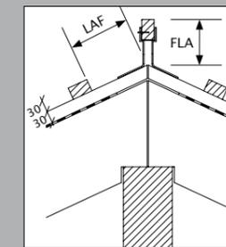
LAF = Lattenabstand zum Firstschnittpunkt (in mm)
